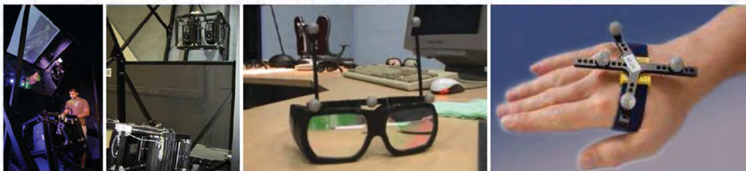
Matériel : (a) et (b) miroirs et projecteurs ; (c) lunettes stéréoscopiques Infitec ; (d) cibles pour le tracking
